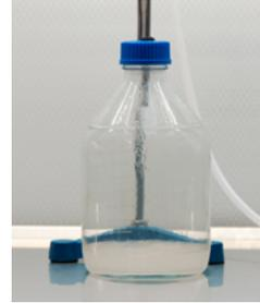
4. Colocar la boquilla metálica de la línea de dispensación en el interior del frasco suministrado.
