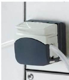
**2.** Pinzar la línea de dispensación con la bomba peristáltica y proceder al cierre de la puerta del equipo.
