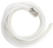
3 tuyaux de silicone renforcée de 2 m et de Ø 9x16 mm avec un raccord rapide au préparateur de milieux et un raccord libre au système d'évacuation à l'autre extrémité.
